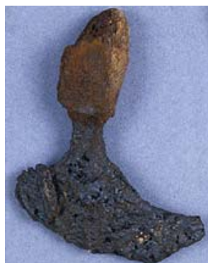
Arkeologiska järnföremål kan ligga helt dolda under kraftiga korrosionsskikt. Med hjälp av röntgen kan konservatorn få information om föremålets form och grad av nedbrytning; de mörkare partierna visar mer långtskriden korrosion som kräver särskild uppmärksamhet under konserveringsarbetet. Efter frampreparering har denna krumkniv genomgått urlakning och rostskydds- behandling. Foto: Katarina Lampel
