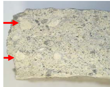
Fig. 19: Kalkklumpar i arriccion, vilket tyder på att stuksläckningsmetoden har använts.
