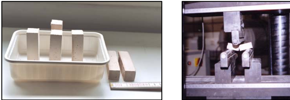
Fig. 17: Provkropparna som motsvarar originalputsens (arriccions) materialegenskaper. Bilden till vänster visar de fukttekniska testerna (vattenupptagningsförmågan). Bilden till höger visar hur de mekaniska egenskaperna provas i en tryckpress.
