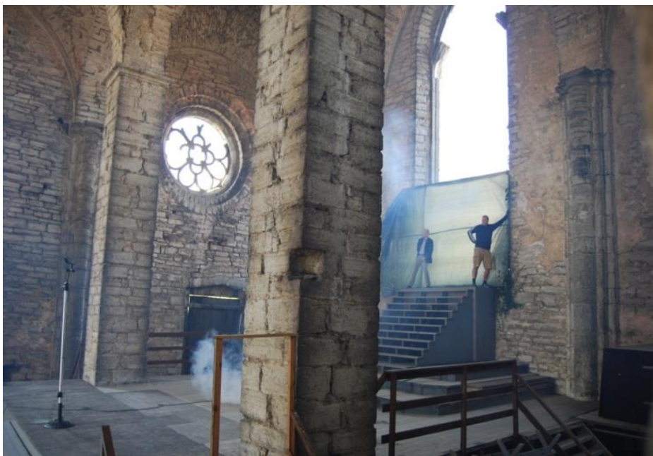
Bild 8.5. Vindavskärmningen täckte cirka 1/3 av fönsterytan.
