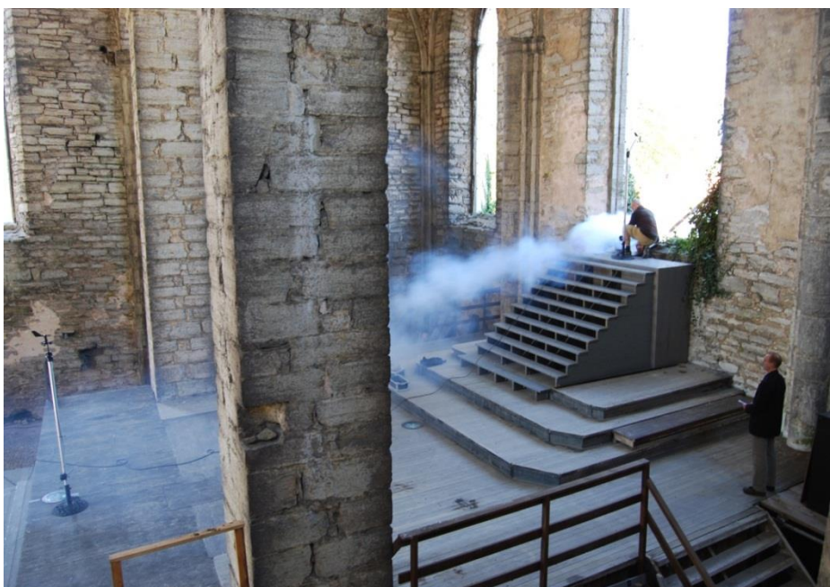
Bild 8.4 Längre fram på scenen är den västliga luftrörelsen fortfarande stark. Försök med rök i maj 2010.
