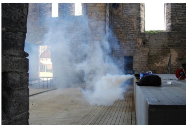
Bild 8.7 Trots en kraftig vind i västlig riktning rör sig luften sakta mot söder.
