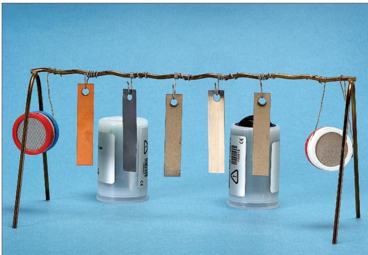
Figur 4. Exponering av provsamlare och metallkuponger samt mätning av temperatur och relativ luftfuktighet. Foto: Gabriel Hildebrand, RAA.
