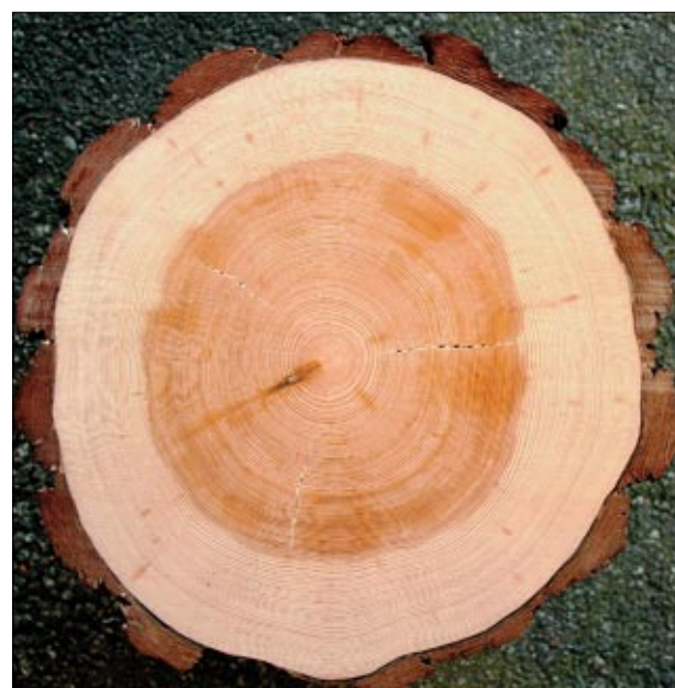
Figur 15. Kärnved och splintved i furu. Foto: SP-Träteknik.
